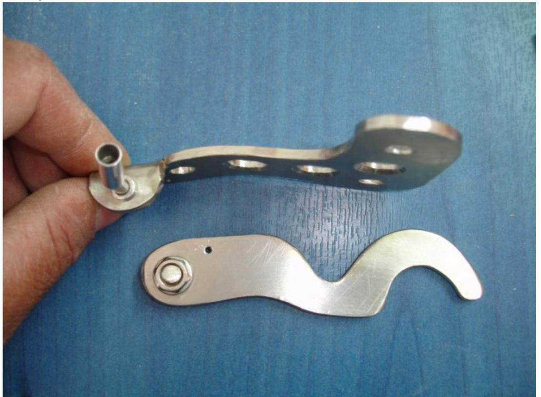
esta pieza se coloca en la parte trasera de la bomba de freno.
